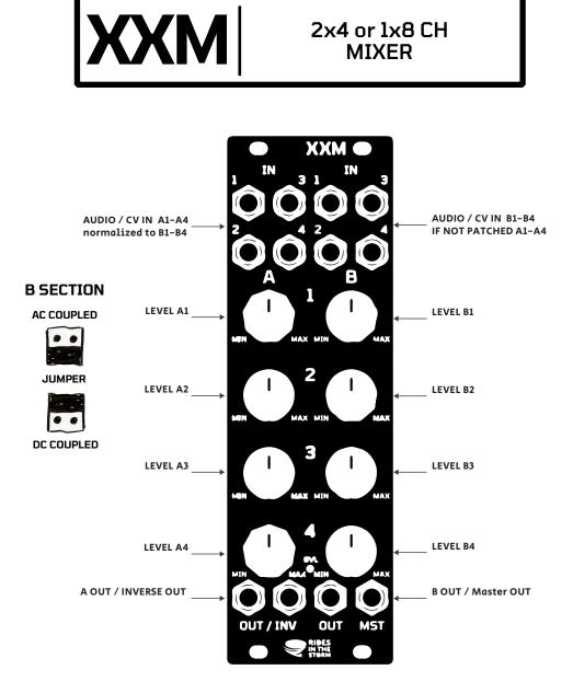
SUBERB LOW NOISE & LOW DISTORTION QUALITY FOR AUDIO SIGNALS AND CONTROL VOLTAGES. MIXER A AND MIXER B WITH 4 INPUTS EACH AND LEVEL CONTROL KNOB PER CHANNEL. STEREO APPLICATION IF ONLY MIXER A1-A4 IS USED (A IS NORMALIZED TO B) MIXER A IS DC COUPLED AND WITH POSITIVE AND INVERTED OUTPUTS MIXER B SWITCHABLE BETWEEN AC/DC COUPLING VIA JUMPER, COMMON MASTER OUTPUT
